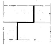
VERTICAL EXPANSION JOINT WITH HORIZONTAL OFFSET
