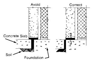
EXPANSION JOINT OVER CONCRETE SLAB FIG. 22
